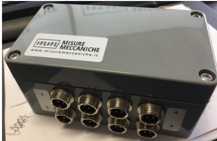
Centralina 16 canali per prova di carico cablata.
